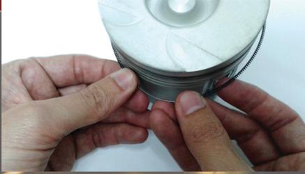
Luego enrolle el resorte en espiral en la tercera ranura y cierre el círculo. Es importante insertar la juntura hasta que los dos extremos del resorte se toquen.
