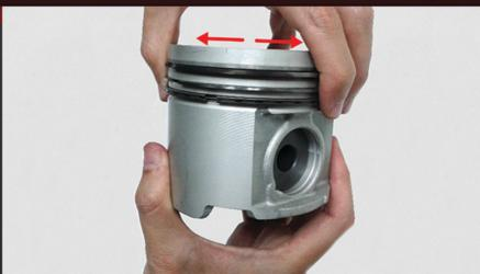
Verifique que los anillos instalados puedan girar sin dificultad dentro de las ranuras del pistón, como se muestra en la imagen. Verifique que no haya anillos difíciles de girar, ya que pueden estar deformados o las puntas pueden estar traslapadas.
