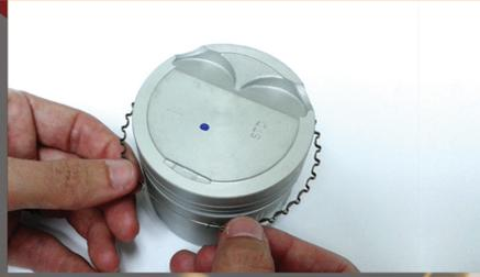
Abra el anillo que parece un resorte, llamado Spacer Expander (expansor-espaciador), meta el lado opuesto a la abertura del espaciador en la tercera ranura. Coloque el otro extremo dejándola tener contacto con la cabeza del pistón. Si instala los anillos de compresión primero, es muy difícil instalar los anillos aceiteros.
